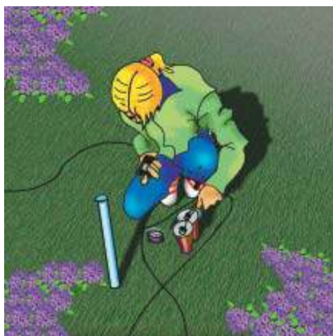
Figura 3. El coeficiente de uniformidad se determina mediante la medición del volumen de agua suministrado por cada gotero.
