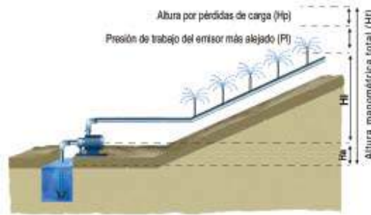
Figura 8. Representación esquemática de la altura manométrica total.
