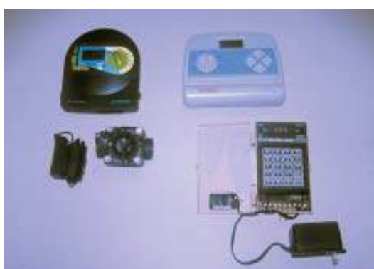
Figura 3. Distintos modelos de programadores y electroválvulas.
