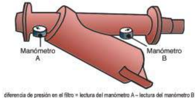
Figura 2. Determinación de la diferencia de presión existente a la entrada y a la salida de un filtro de malla.
